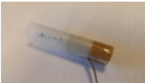
Senzor vlhkosti steny, bočný pohľad. Otvorený koniec dovnútra otvoru.
