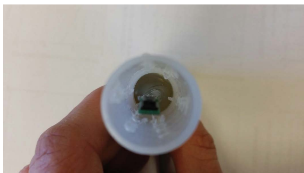
Senzor vlhkosti steny, pri pohľade z vnútorného konca. Čip senzoru je možné vidieť vo vnútri trubice.
